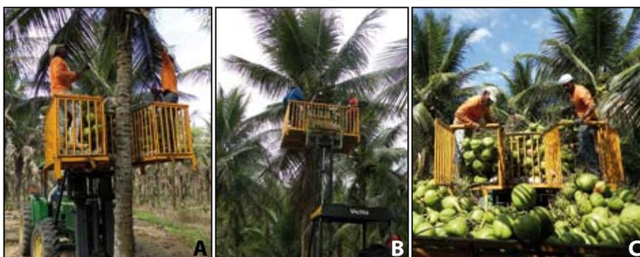
**Figura 55.** Plataforma em operação de colheita (A) e (B). Descarga dos frutos sobre a carreta agrícola (C).
