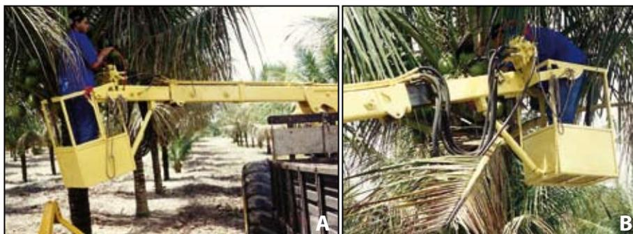
**Figura 52.** Colheita dos cachos de coco realizada com braço mecânico hidráulico na Fazenda Rio Preto, município de São Mateus, ES (A) e (B).
