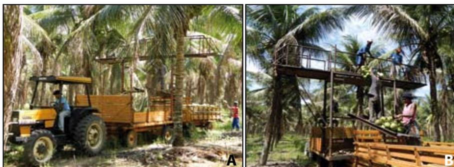
**Figura 53.** Plataforma desenvolvida para a colheita de frutos de coco verde (A). Operação de colheita com a plataforma (B).
