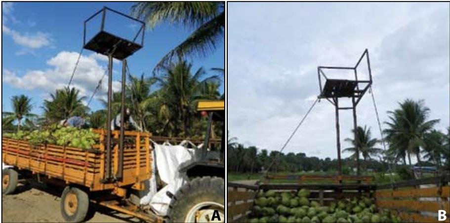
**Figura 51.** Plataforma fixa adaptada sobre uma carreta agrícola para colheita de coco verde (A) e (B).
