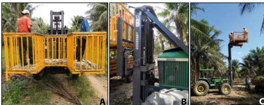
**Figura 54.** Plataforma tipo semigaiola desenvolvida para a colheita de coco (A). Torre de elevação de uma empilhadeira (B). Elevação da semigaiola através do sistema hidráulico (C).
